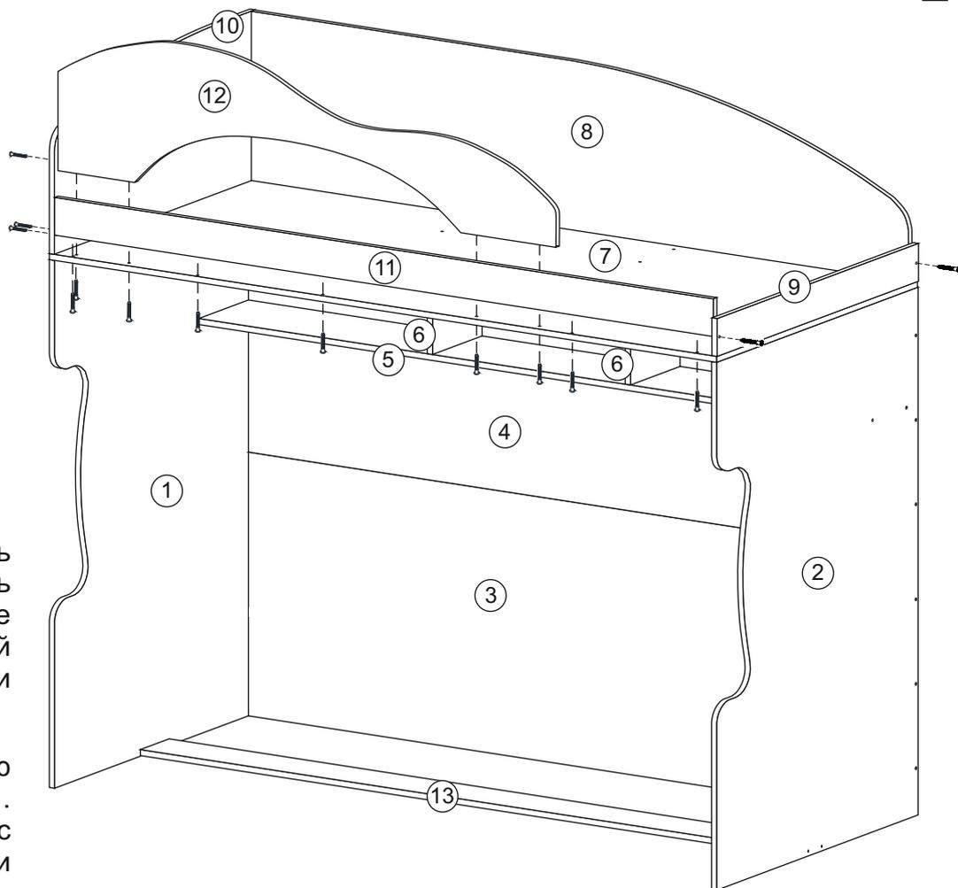
8. На деталь 7 установить боковины 11 и 12 и закрепить еврошурупами 7\*50 мм. Далее скрепить между собой еврошурупами 7\*50 мм щитки 10 и 9 с боковинами 11, 12 и 8.
