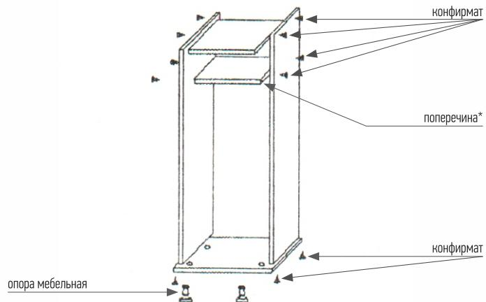
Примечание: \*Присадка данной детали производится непосредственно по месту сборки в зависимости от высоты конкретной модели.
