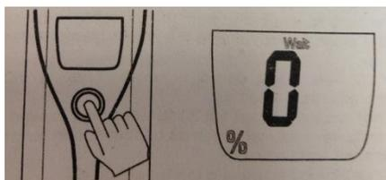
2. На дисплее прибора загорится индикатор «Wait», замигает цифра «0», начнется период нагрева датчика.
