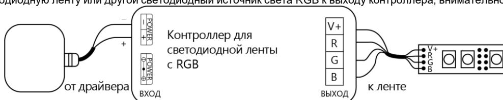
**ПРЕДУПРЕЖДЕНИЕ: ЗАПРЕЩЕНО ОСУЩЕСТВЛЯТЬ ОДНОВРЕМЕННОЕ ПОДКЛЮЧЕНИЕ ИСТОЧНИКОВ ПИТАНИЯ ЧЕРЕЗ РАЗЪЕМ И ЧЕРЕЗ КЛЕММНУЮ КОЛОДКУ.**
