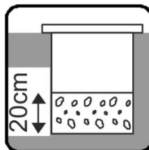
5.4 Проверьте работоспособность дренажной системы. Для этого заполните монтажную лунку водой и проверьте удалась ли вода за 30 минут. Если этого не произошло, то увеличьте высоту дренажной системы, либо рассмотрите возможность монтажа водоотводящего трубопровода.
