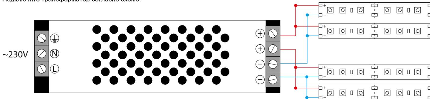
*При подключении трансформатора следует ориентироваться на расположение клемм, обозначенное на корпусе, т.к. оно может незначительно отличаться от того, что на изображении.*
