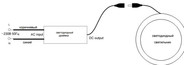
4.6 Установите светильник в монтажной нише как показано на схеме:
