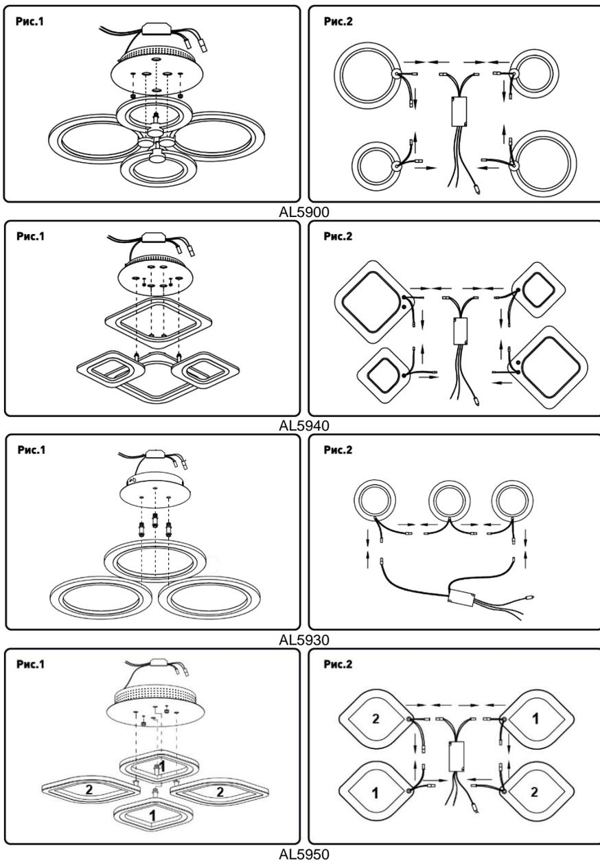
5.8 Подключите питающий кабель сети переменного тока к клеммной колодке согласно схеме:
