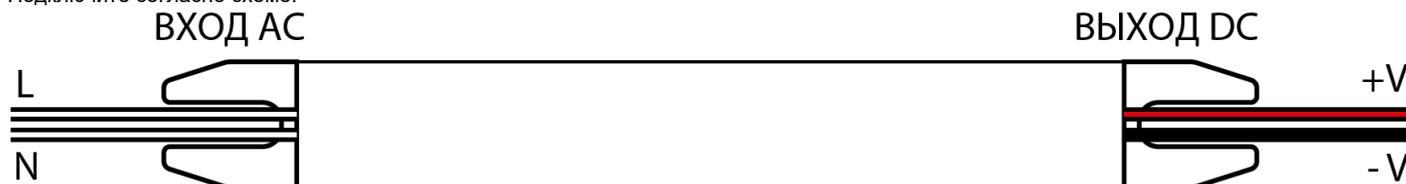
При подключении трансформатора следует ориентироваться на расположение клемм, обозначенное на корпусе, т.к. оно может незначительно отличаться от того, что на изображении.
