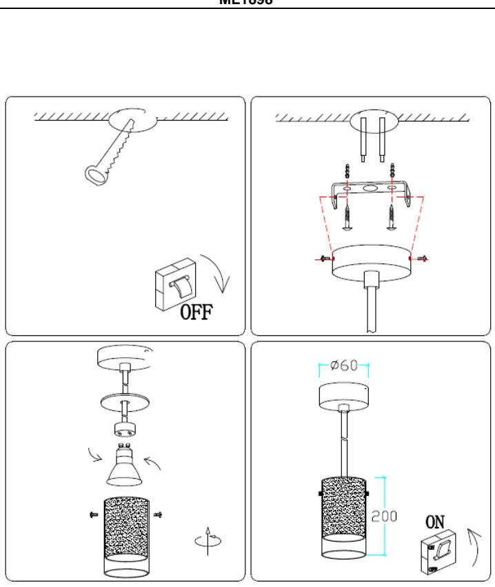
1. Закрепите скобу светильника на монтажной поверхности при помощи саморезов.
