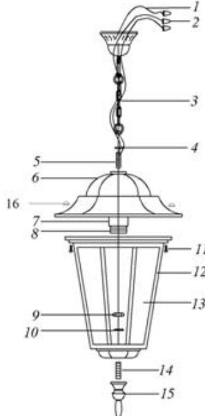
1 – провод заземления; 2 – провода питания; 3, 4 – цепь подвеса; 5 – малое резьбовое крепление; 6 – алюминиевая крышка; 7 – ламподержатель; 8 – керамический патрон; 9 – гайка; 10 – гровер; 11 – крепежные винты; 12 – металлический каркас; 13 – стеклянный рассеиватель; 14 – большое резьбовое крепление; 15 – декоративная балюсина.
