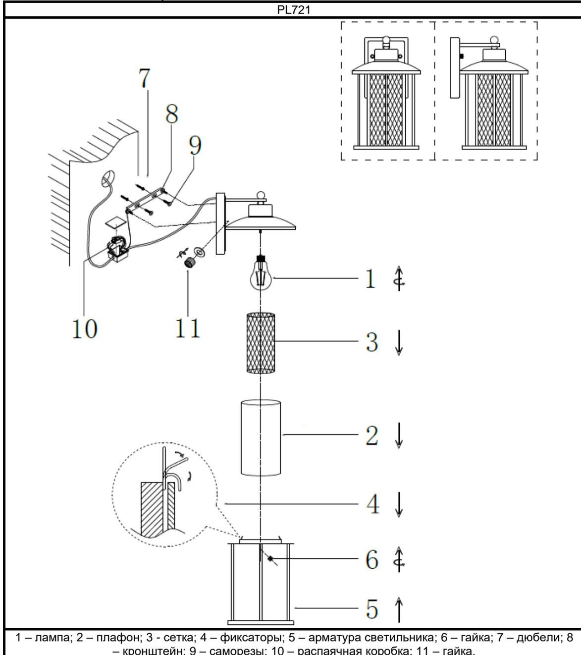
1 – лампа; 2 – плафон; 3 - сетка; 4 – фиксаторы; 5 – арматура светильника; 6 – гайка; 7 – дюбели; 8 – кронштейн; 9 – саморезы; 10 – распаячная коробка; 11 – гайка.
