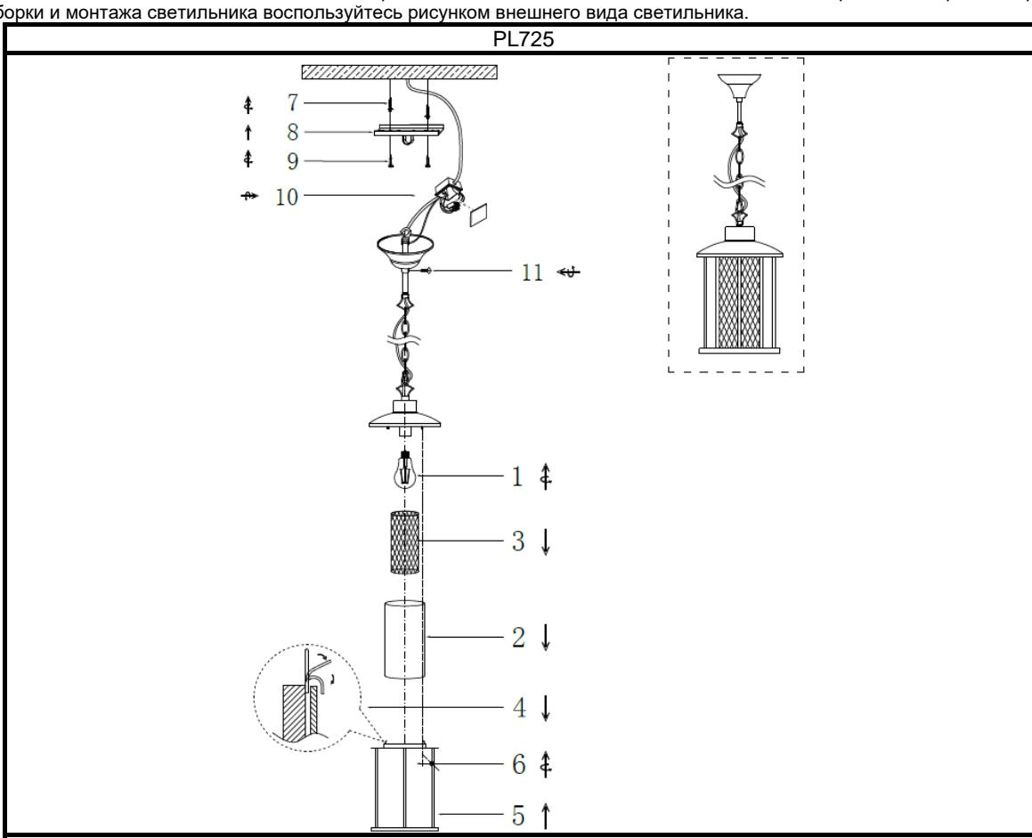
1 – лампа; 2 – плафон; 3 - сетка; 4 – фиксаторы; 5 – арматура светильника; 6 – винт; 7 – дюбели; 8 – кронштейн; 9 – саморезы; 10 – распаячная коробка; 11 - винт.
