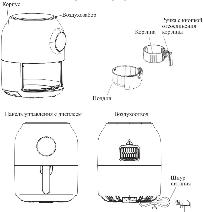
Принцип работы аэрогриля основан на конвекции воздушных потоков от нагревателя внутри рабочей емкости. Вентилятор, расположенный в верхней части аэрогриля, приводит в движение воздушные массы, нагретые до высокой температуры ТЭНом (трубчатым электронагревателем). Горячий воздух циркулирует внутри рабочей емкости аэрогриля и нагревает продукты до нужной кондиции.
