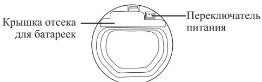
**Переключатель питания** включает и выключает работу датчиков. Для включения датчиков переместите переключатель в положение «|». При перемещении переключателя в положение «0», датчики отключаются.
