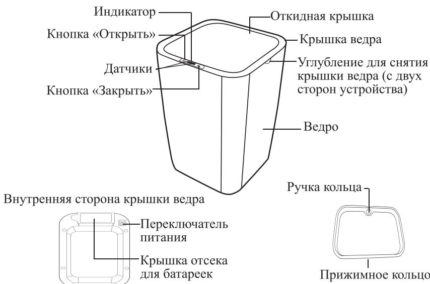
**Переключатель питания** включает и выключает работу датчиков и кнопок. Для включения переведите переключатель в положение «1». При переводе переключателя в положение «0», сенсорное мусорное ведро отключится.
