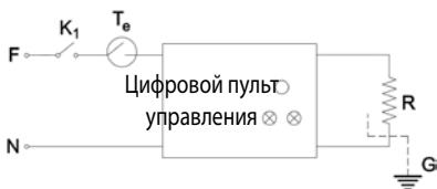
Рисунок 4. Схема электрического цикла Панельного Конвектора с цифровым показателем
