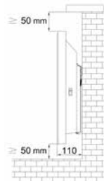
الشكل ١١ مقاييس جهاز لوح التسخين الكهربائي بعد التركيب
