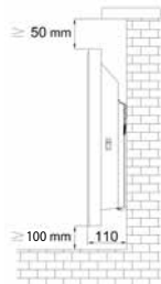
Imagen 11 Medidas del convector montado.
