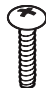
Винты для подставки 2 шт., M4 x L16 (только для 29MT40*, 29MT45*) (см. стр.11, 13)
