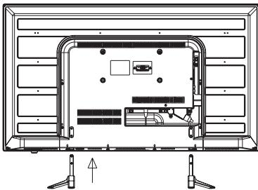
3. Закрепите стойки при помощи 4-х винтов (входят в комплектацию прибора)
