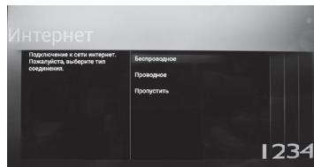
При осуществлении доступа посредством технологии WiFi выберите «Беспроводное», при подключении к сети посредством Ethernet кабеля (стр.11 поз.11) выберите «Проводное». Произведите необходимые настройки согласно настройкам Вашего роутера и информации от интернет провайдера. Данный этап можно пропустить и вернуться к нему позднее, зайдя в раздел настройки в режиме Smart TV.
