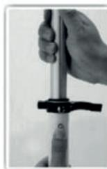
Откройте механизм натяжения на рулевой колонке, нажмите на кнопку, опустите руль.
