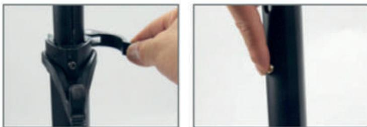
Откройте механизм натяжения на рулевой колонке, поднимите телескопическую стойку до необходимой высоты и направьте ее в соответствующие отверстия до щелчка.
