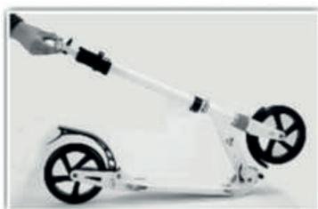
Откройте механизм на рулевой колонке и нажмите фиксирующий рычаг вперед, чтобы разблокировать механизм складывания.
