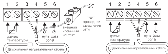
Схема подключения к 3-х проводной электрической сети
