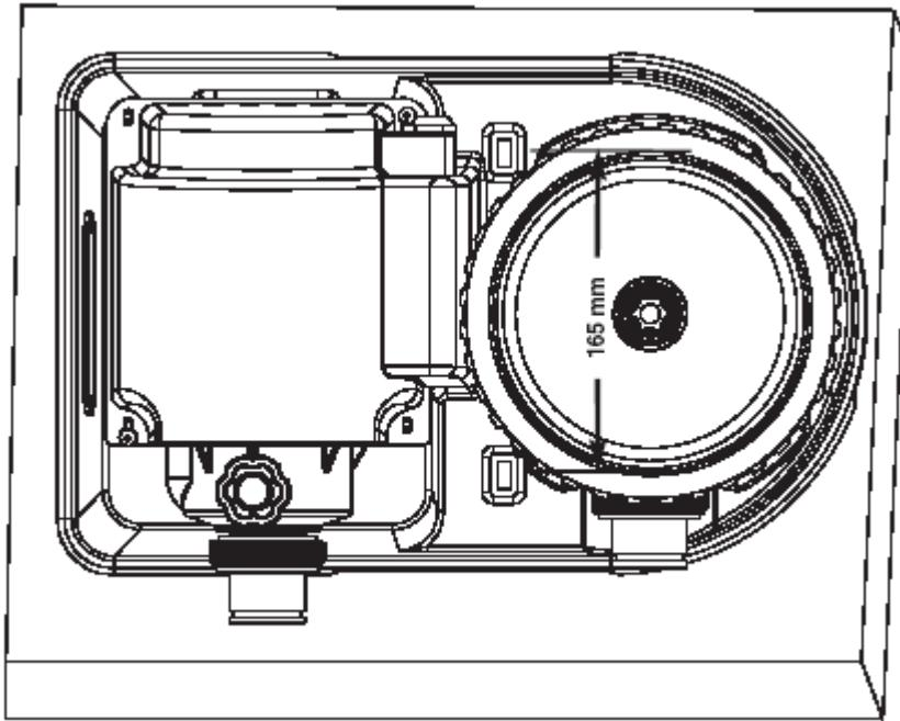
1. Крепежные отверстия имеют диаметр 6.4 мм и удалены друг от друга на 165 мм
