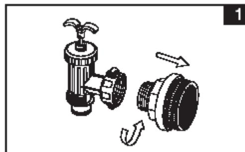
3. Движением против часовой стрелки открутите Муфту (12) от Соединителя (14). Оставьте Шайбу (13) на Соединителе.
