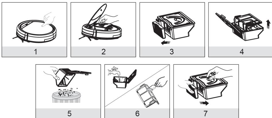
Фильтр тонкой очистки можно вынуть, потянув назад за выступ сверху на рамке-держателе. Его можно почистить с помощью щетки или промыть водой. Вы можете промывать водой пылесборник и основной фильтр. Не забудьте их просушить перед установкой в пылесос.
