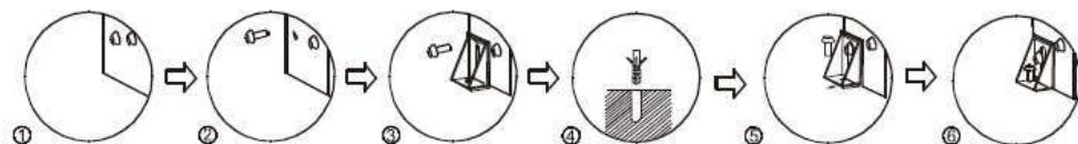
**ВНИМАНИЕ! Во избежании опасности из-за неустойчивости прибора, он должен быть зафиксирован в соответствии с инструкцией./ATTENTION! In order to avoid danger because of dispenser instability it must be fixed in accordance with the instructions.**
