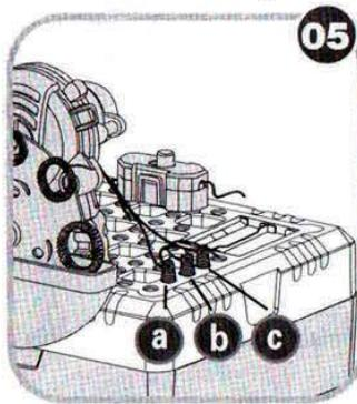
**5. Подключите 2 черных провода к соединителю (a). Затем подключите красный провод от вентилятора (5) к соединителю (b). Подключите красный провод от включателя к соединителю (b).**
