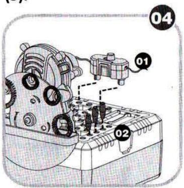
**4. Установите включатель (1) на базе с отверстиями (3). Затем установите 3 соединителя (2), узким концом вниз.**
