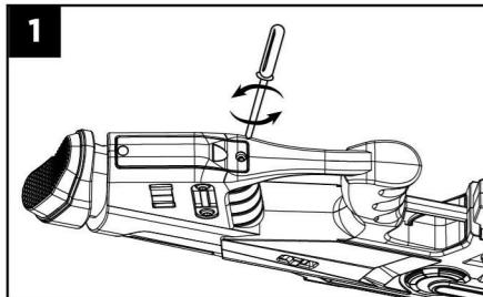
Используйте отвертку, чтобы открыть отсек под батарейки
