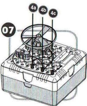
7. Соедините черный провод мотора с соединителем (4a),
