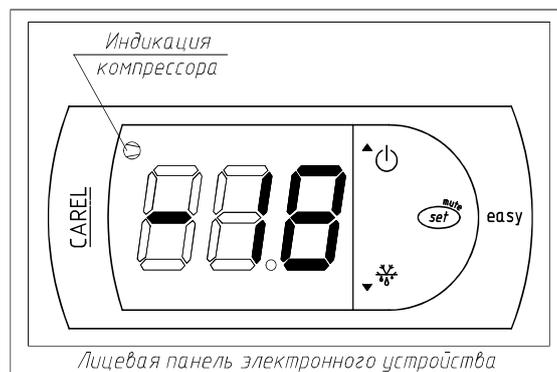
**ВНИМАНИЕ!** Включение компрессора происходит через одну минуту после подключения к сети, при этом загорается индикатор в левом верхнем углу дисплея. После того как температура достигнет заданной, изделие начинает работать циклично.
