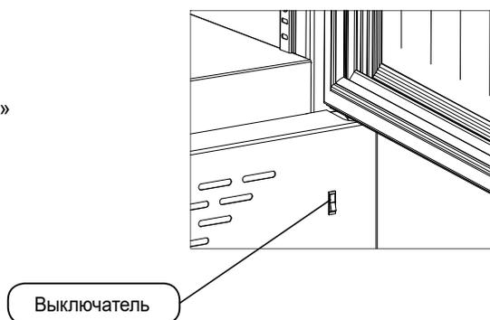
В шкафах: «Бирюса 460KDNQ»; «Бирюса 460KDN»; 520KDNQ»; «Бирюса 520KDN» включение светильника осуществляется автоматически при открытии двери. При закрытии двери свет гаснет.
