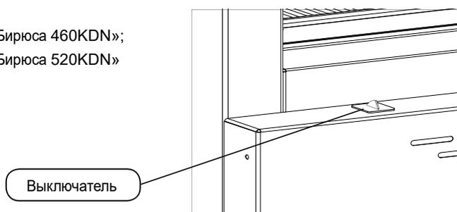
**Вентиляторы** Включение-выключение вентиляторов осуществляется автоматически. После открытия двери - прекращают вращаться, а при закрытии двери - начинают работать.
