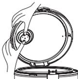
2. Разберите паровой клапан на 2 части, поворачивая паровой затвор вправо и влево.
