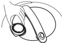
Если возникли трудности при извлечении парового клапана, вытолкните его с внутренней стороны крышки
