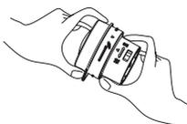
3. Тщательно промойте паровой клапан и затвор. Будьте аккуратны, чтобы не повредить уплотнительную прокладку.
