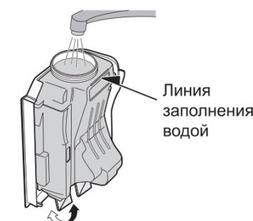
Водяной бак может быть поднят своим кронштейном (Кронштейн водяного бака вращается.)
