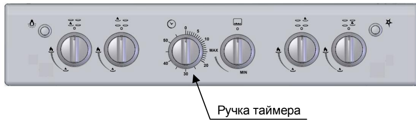
Рисунок 3а – Панель управления с таймером
