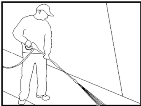
Рис. 6 - Оптимальный угол распыления воды относительно поверхности
