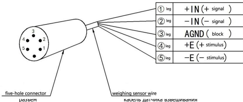
Рисунок 8 (подключение разъема)
