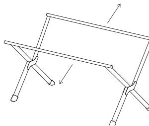
2. Развернуть столешницу и закрепить на каркасе за счет специальных фиксаторов с четырех сторон.
