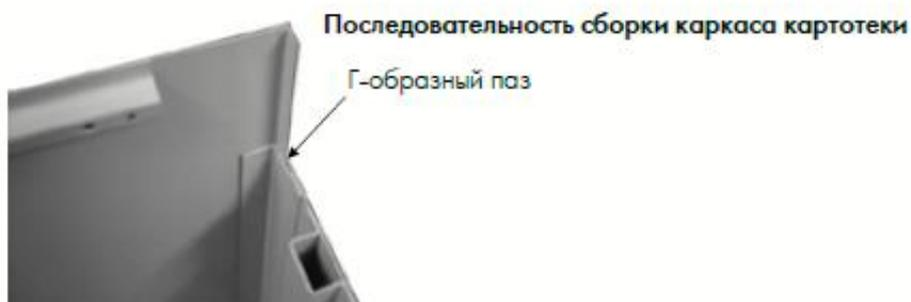
Две боковые стенки (рис.14, 15) ставятся и удерживаются параллельно друг другу. Задняя стенка (рис.16) вставляется в Г-образные пазы боковых стенок (рис. 25) и задвигается вниз до упора (рис. 26).
