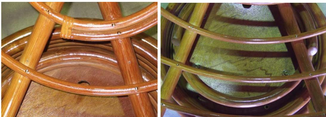
3. Вставьте саморезы ( $d = 4.2$  мм,  $L = 60-65$  мм) в просверленные отверстия, а затем закрутите их до упора.
