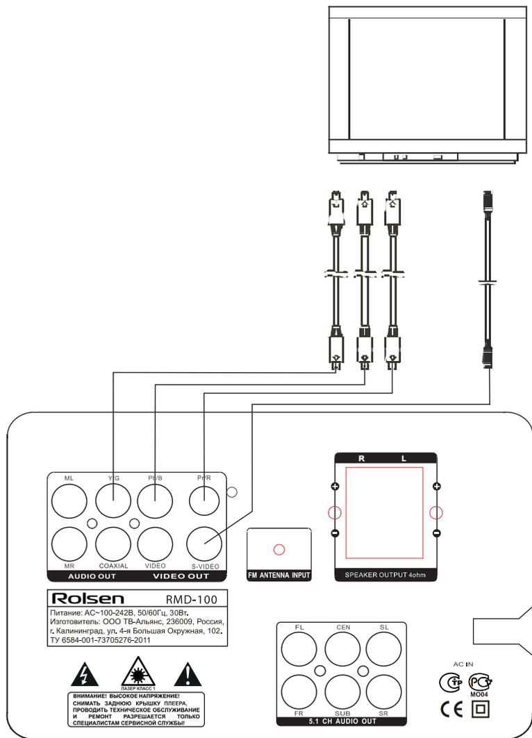
**Внимание:** На рисунке представлена схема подключения микросистемы RMD-100, подключение микросистемы RMD-300 производится аналогичным образом.
