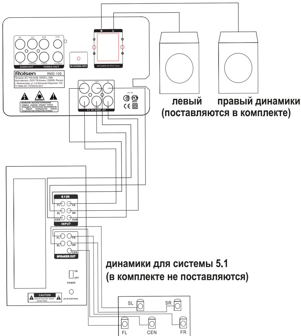
**Внимание:** На рисунке представлена схема подключения микросистемы RMD-100, подключение микросистемы RMD-300 производится аналогичным образом.
