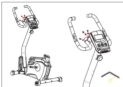
Зафиксируйте поручни к стойке, предварительно соединив кабели пульсометров.
