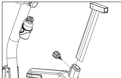
Установите опору сидения и закрепите фиксатором, как указано на рисунке.
