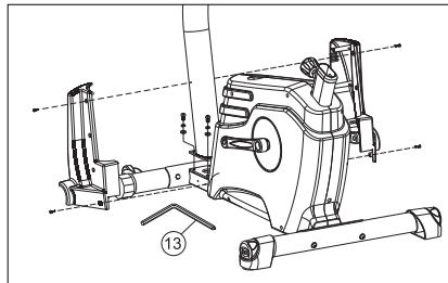
Установите переднюю стойку №3 на основание тренажера, соединив предварительно провода. Осторожно – не пережмите провода! Также вставьте и соедините трос регулятора нагрузки в стойке снизу. Затем установите пластиковые кожухи справа и слева.
