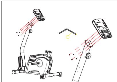
Соедините кабели в стойке с коннектором в дисплее и извлеките кабели пульсометров в отверстие спереди стойки. Закрепите консоль болтами к стойке.
