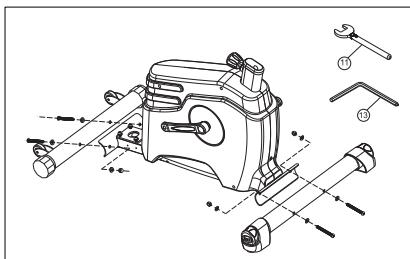
Закрепите переднюю и заднюю опоры на основной раме с помощью болтов и инструментов №11 и №13.
