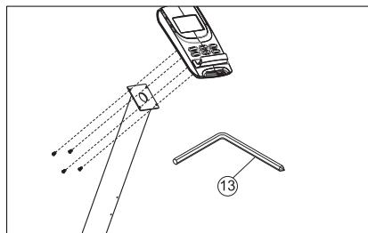
Заденьте регулятор нагрузки согласно фото болтами и ключом №13.
