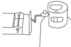
2. Через специальное отверстие в отсеке для газового баллона проведите шланг с переходником во внутреннюю часть.
