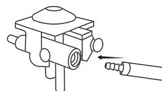
3. Прочно соедините резьбу переходника с соответствующим отверстием в редукторе.
