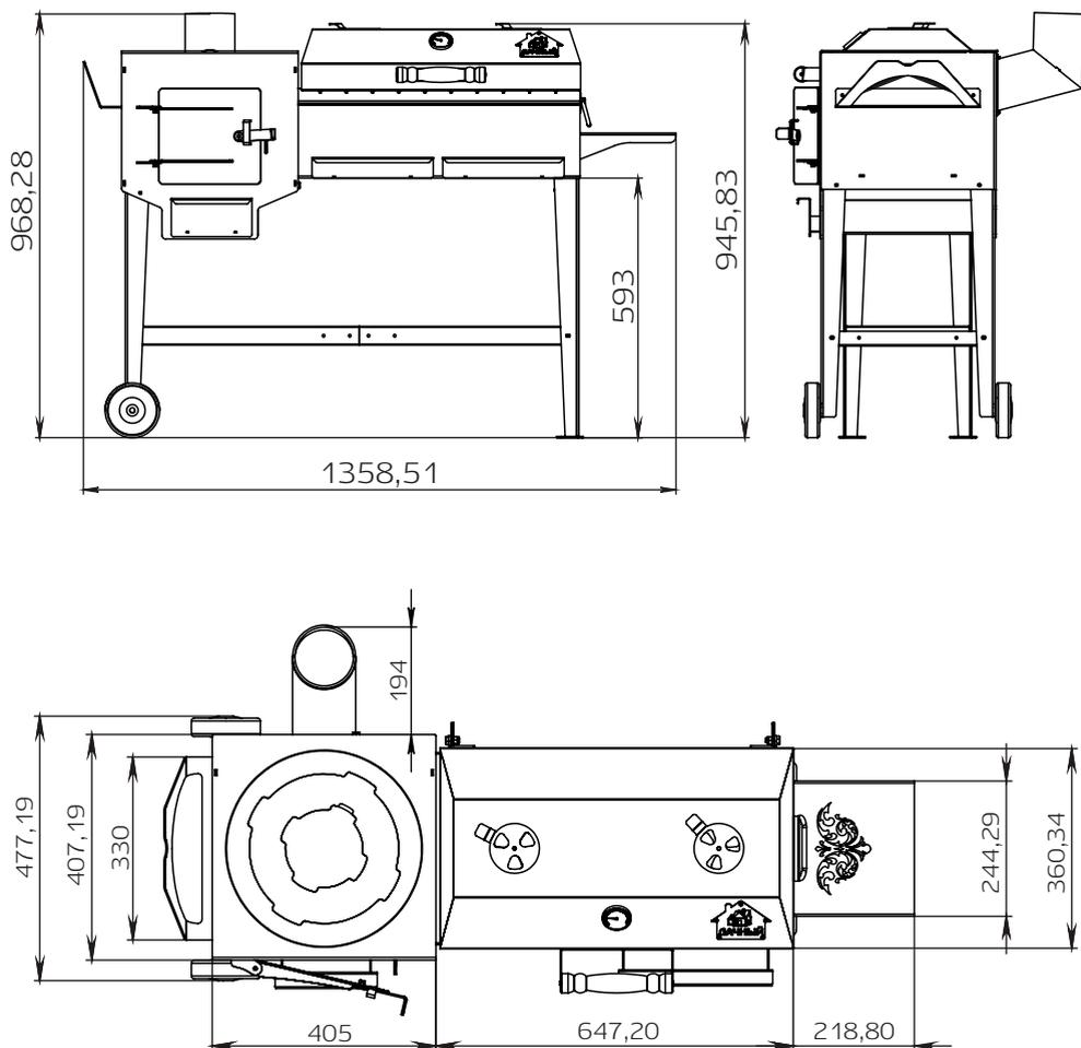
Рис. 1 - Габаритные размеры
