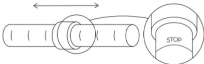
3. Зафиксировать нижнюю секцию палки с помощью замка.
