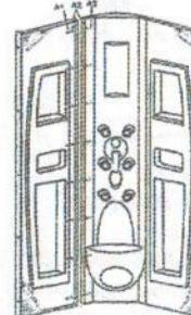
3) Смонтируйте переднюю стеклянную ширму с подвижными дверями и закрепите её к задней стенке:
