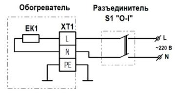
Рис. 2.1 Схема подключения обогревателя IR-08, IR-10
