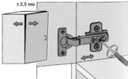
Освободить крепежный винт и отрегулировать расстояние между дверью и боковой шкаф. Затем крепежный винт снова затянуть.
