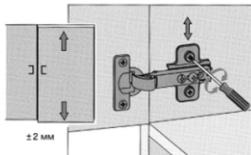
При помощи отвертных планок, регулируемых по высоте, можно точно установить высоту положения двери.
