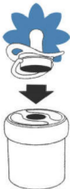
Включение устройства «Светля-чок-СМ» обеспечивается касанием магнитного ключа-крышки тыльной стороны корпуса соски. Синий светодиод встроенного в соску оп-тоэлектронного блока вспыхнет и погаснет. Это означает готовность устройства к работе. После 20 секундной паузы (необходимой для того, чтобы прибор поднести ко рту ребенка) синий светодиод автоматически вновь включается и светит в течение всего сеанса, пока доза облучения не достигнет величины = 0,1 Дж.
