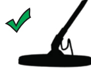
Правильный угол расположения поисковой катушки
