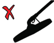
Неправильный угол расположения поисковой катушки
