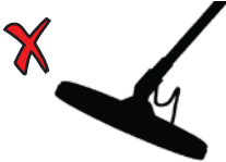
Неправильный угол расположения поисковой катушки
