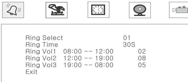
Навигация по разделам меню производится прокручиванием кнопки-колесика. Вход в нужный раздел выполняется нажатием кнопки. Нужный параметр, в выбранном разделе, выбирается так же нажатием кнопки-колесика, а регулирование значений – её прокруткой.
