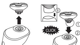
Для получения хороших результатов рекомендуется заменять бритвенную систему каждые два года. Заменять бритвенную систему можно только на аналогичную систему, предназначенную для использования именно с этой моделью электробритвы.
