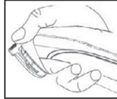
Удерживая машинку в руке, как показано на рисунке, большим пальцем нажмите сбоку на лезвия и снимите их с прибора.
