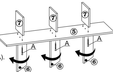
3.3. Последовательно соедините все элементы аналогичным образом. Начиная с полки №5 (с перегородками), затем полка №4 (с перегородками), затем полка №3 (с перегородками), затем полка №2 (с перегородками).
