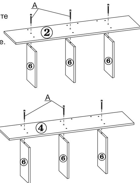
3.2. Поверните перегородки (дет.№6) на 45 градусов, чтобы обеспечить доступ к крепежным отверстиям для установки остальных перегородок (дет.№ 6 и 7). Закрепите детали винтовой стяжкой (поз.А).
